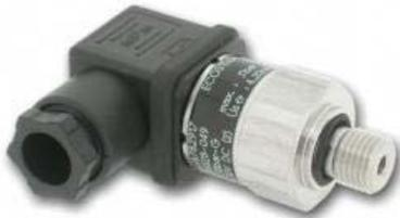
Os transmissores de pressão *ECOS*, são fabricados com tecnologia de filme espesso sobre base cerâmica, resultando num sensor ideal para a maioria das aplicações industriais, sempre que seja requerida uma leitura fiável e com elevado grau de repetibilidade de medições em escalas de trabalho de até 250 bar. Como sinal de saída estão disponíveis duas opções, uma em 4...20mA e outra 0...10Volts. Ficha de ligação DIN43650.
