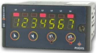
O modelo PLC PCT500 é a solução ideal para integrar função de controlo e supervisão numa única unidade compacta. A função principal do PLC pode ser visualizada no conjunto de displays que permitem ao utilizador o controlo das grandezas ou variáveis presentes. Estão disponíveis quatro entradas analógicas universais para sinais lineares de 0...1V, 0...10V, 0...20mV, 0...20mA, 4...20mA (a 10 ou 16 bit) bem como para sensores de temperatura PT100, NI100, TC K, J, S, T, R, E (16 bit).
