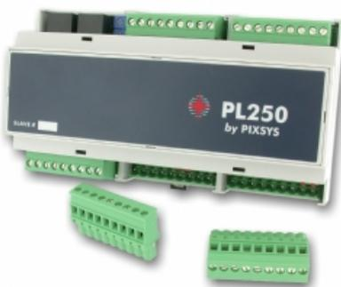
O PLC PL250 é o controlador para colocação em calha DIN para aplicações que requiram flexibilidade com limitações de espaço para a implementação. A sua configuração inclui quatro *inputs* analógicos (resolução de 10/16 bits) para sinais de 0...10Volts / 4...20mA ou sensores RTD / TC, com tensão de 10.0V para possíveis potenciômetros externos e 16 outros *inputs* digitais PNP.
