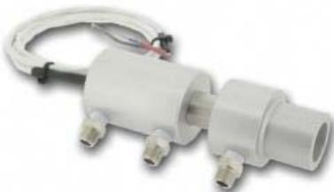
O sensor EL021 é desenhado para trabalhar em ambientes cuja temperatura pode variar desde os 0° aos 50°C. Para operar em ambientes em que as temperaturas sejam superiores, uma camisa especial de arrefecimento água/ar pode ser acoplada ao sensor. O arrefecimento por ar permite que o sensor opere em temperaturas ambientes de até 170°C, enquanto que o arrefecimento por água permite a sua operação até aos 250°C.
